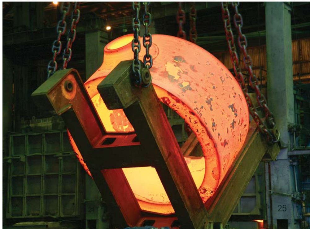
Выштамповка главных патрубков реактора ВВЭР-1000 в ОАО «ОМЗ-Спецсталь»
